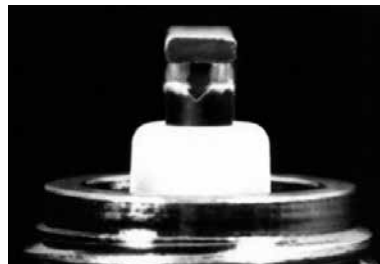
図6-5 V型形状の溝付きプラグの火花放電の様子
