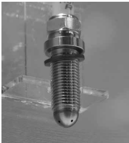
副燃焼室を持ったスパークプラグ。中に副燃焼室があり、そこで点火された炎が先端にいくつかあけられた穴から吹き出し、シリンダー内の混合ガスに多点点火する。
