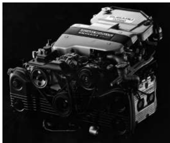
歴史的なEJ20ターボエンジンの登場時の写真。EA型とは当然様相が変わり、DOHCとなったことで、ヘッドの大きさが目立つ。
