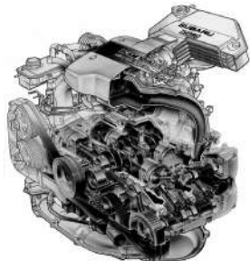
EJ20ターボの透視図。ブロック真上にターボが置かれ、その後方（図の右）に水冷インタークーラー。タイミングベルトは長大で、左右4本のカムシャフトすべて1本でまかなう。右側カムシャフトのひとつ左の小さいプーリーがウォーターポンプ。ベルトの耐久性についてはEA52のときよりノウハウが蓄積されていた。1本にすることでベルト幅も広くとれた。
