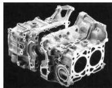
EJ20シリンダーブロック。ブロックと一体のクランクケースは5カ所（5ベアリング）で左右からクランクシャフトをがっちり挟み込み、ケース自体も剛性が高い。フライホイールハウジングも一体成型で、さらにクロードデッキとして、剛性を万全にした。
