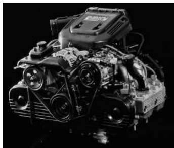
SOHCを採用したEJ18エンジン。4バルブとはいえSOHCなので、ヘッドはEA型からそれほど大型化していない。補機類配置やベルトのとりまわしは大きく変わっている。
