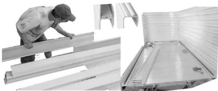
アルミブロック組立式バンの例（インドネシアのボディビルダーにて）
