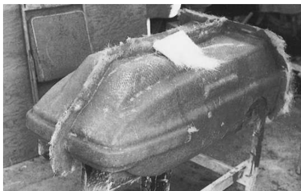
盲導犬ボディの雌型の精磨を終えたところで、3分割になるフランジの形が分かる。
