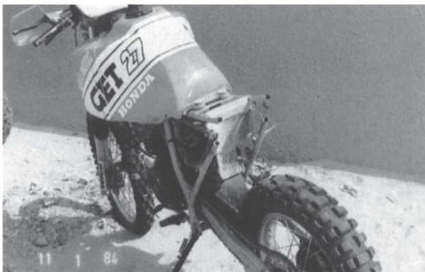
次々とトラブルが発生する。上の写真はエンジンの異常燃焼による損傷。といってもこうなるとエンジンの中はメチャメチャだ。下のホンダXLはリアフレームがボッキリと折れてしまっている(女性ライダー、ベロニクのマシン)。
