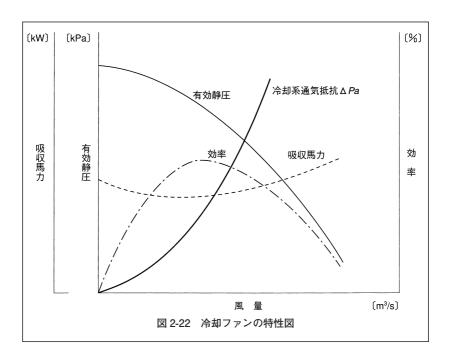
この特性図に冷却系の通気抵抗をプロットすれば、車載した場合の風量 が得られる。
