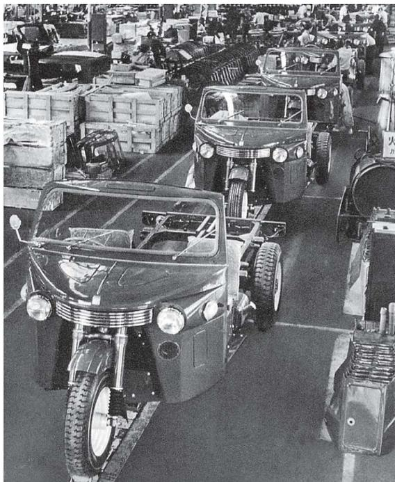
1950年代半ばのダイハツのオート三輪車組立工場内の様子。レール上を移動するオート三輪車に部品を組み付けている。
