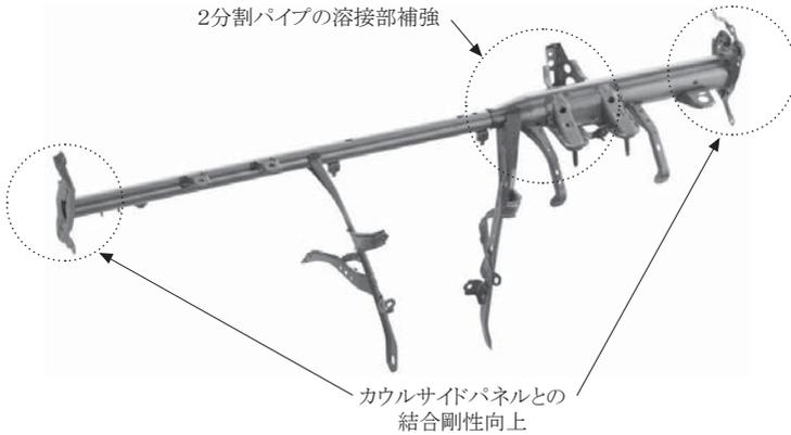
図16-4 ステアリングサポートの剛性向上<sup>(1)</sup>
