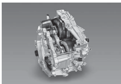
複軸化されたトランスアクスル。モーター出力は従来比30%向上。減速エネルギー回生の容量も倍増している。
