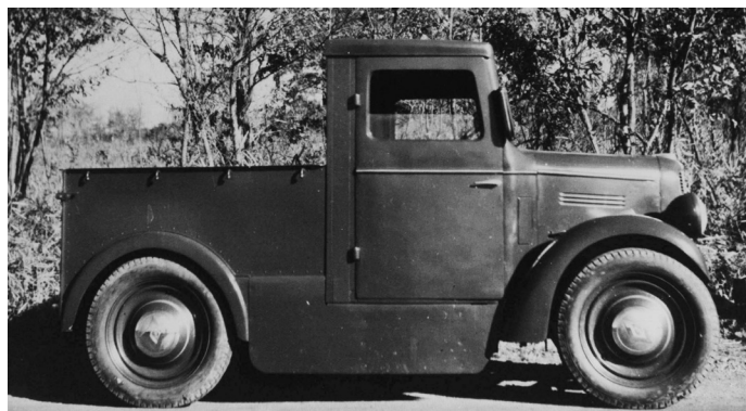
オオタ号を改良して製作した最初の電気自動車。この試作車は1946年に完成
