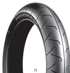
**BT-012SS** サーキット走行用ながらレース専用ではなく、ワインディングやサーキットへの移動でも使えるという位置付けとなっている。そのためDBC(デュアル・ベルト・コンストラクション)を採用、ケブラーのモノスパイラルベルト(0度ベルト)の外側に、クラウン部を残して左右別々に1プライのクロスベルト(角度は60度)を重ねることで、直進時は0度ベルトの効果で高速安定性を、コーナリング時はクロスプライベルトの効果で高いグリップ性能を得ている。タイヤ設計には3D-CTDMという3次元的にタイヤを解析する手法を適用、バンク角によってリニアに移行する接地圧や横剛性が得られるようプロファイルを設定、BT-012SSはフロントのクラウン部のラジラスを小さくしたものとしている。また新採用のシリカリッチコンパウンドはシリカの配合率を高めたものである。
