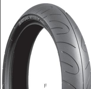
**BT-090** パターンのネガティブ比が小さいレース用タイヤで、ミドルクラス用のサイズ設定。パターンはサイド部の剛性を考慮したものとなっている。このBT-090はリヤにモノスパイラルベルト(0度ベルト)を採用(クロスプライでの補強は追加されている)するが、ビッグバイクレース用のBT-001の場合は、レーシングスリックと同じく、2プライのクロスベルト構造となっている。
