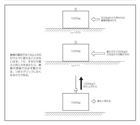
その抵抗力も増す。幅広い粘着テープのほうがしっかり貼り付けられるのと同じである。テープの場合は押し続けることはないが、タイヤの場合は通常荷重が掛かっているので、押し付ける力も働いている。この力が大きければ抵抗力も比例して増すことは固体の摩擦の場合と変わらない。
