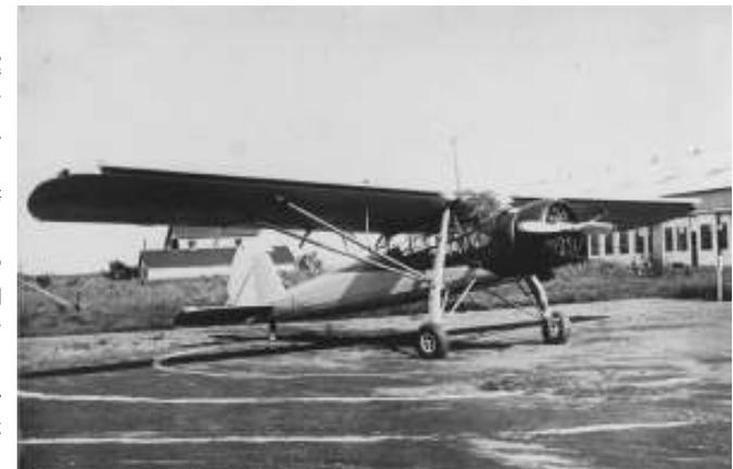
益浦幸三氏は学生時代、フォッカー・スーパーユニバーサル機(写真)を参考に卒業設計をしたとのこと。後に設計する寺田航研TK-3の胴体(鋼管溶接によるトラス構造)や主翼(全木製の合板張り)の構造は、この機体の構造をほぼ踏襲している。(提供:日本航空協会)
