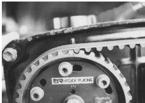
図4-14 トヨタ4A-Gエンジンの合いマーク クランク目盛りを0°(1番圧縮上死点)に合わせるとき、ギアの合いマークはバックプレートのタテの凸部と一致する。これを合わせる。
