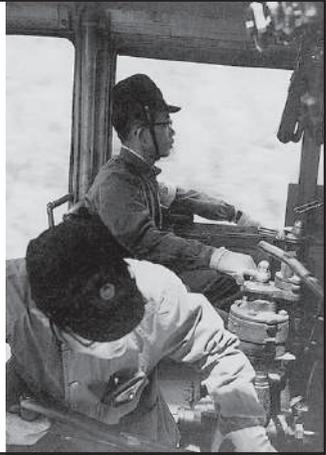
る。汚れは煙突から出た水性のものなので、ボロ布でふけば簡単に落ちる。架線を張ってから感電事故防止のため、ボイラーの上部横断が禁止されて反対へ回るのが面倒になった。手すりをはじめ、座席まわりや機関士の扱う機器など触る部分も拭しておく。
