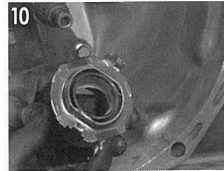
10 ベアリング内周およびリリースフォーク接触部にもクラッチグリスを塗る。
