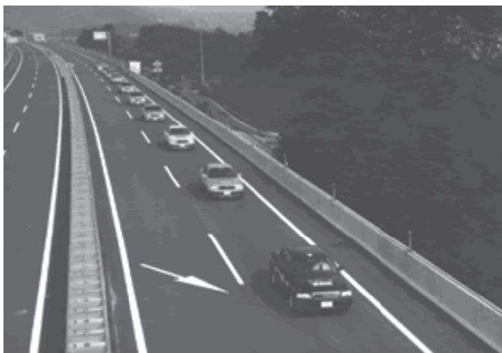
図 1.12 上信越自動車道での AHS 自動隊列走行の実証実験
