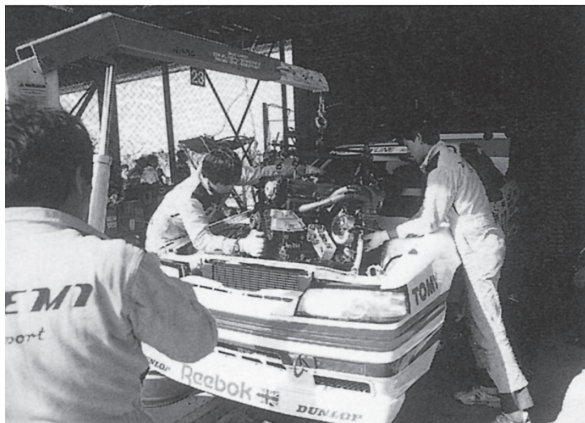
ガレージでのエンジンの搭載作業 R31GTS-Rのエンジンはボアアップされ2027ccになっており、最終的には450ps(予選時)までの出力を発生した。ターボの過給圧も1.68kg/cm 2 まで上げられ、最高回転速度は6500rpmまで引き上げられた。
